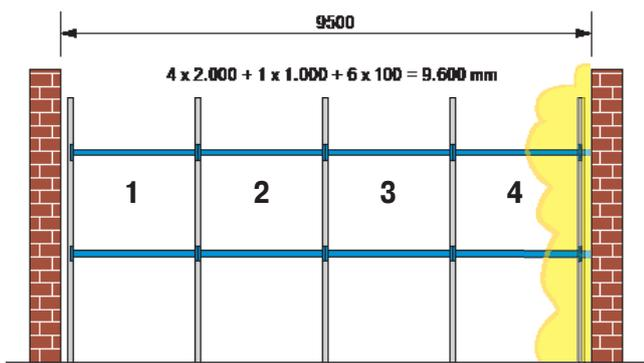
Do sada:  $4 \times 2.000 + 1 \times 1.000 + 6 \times 100 = 9.600 \text{ mm}$
