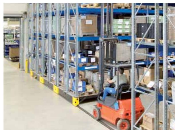
viličarem. Rješenjem je na optimalan način iskorišten raspoloživi skladišni prostor. Pristup do svake palete moguće je u bilo kojem trenutku otvaranjem ili zatvaranjem željenog hodnika.
