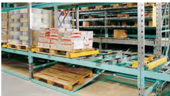
Empty pallet return system, BITO-type »ASP«
