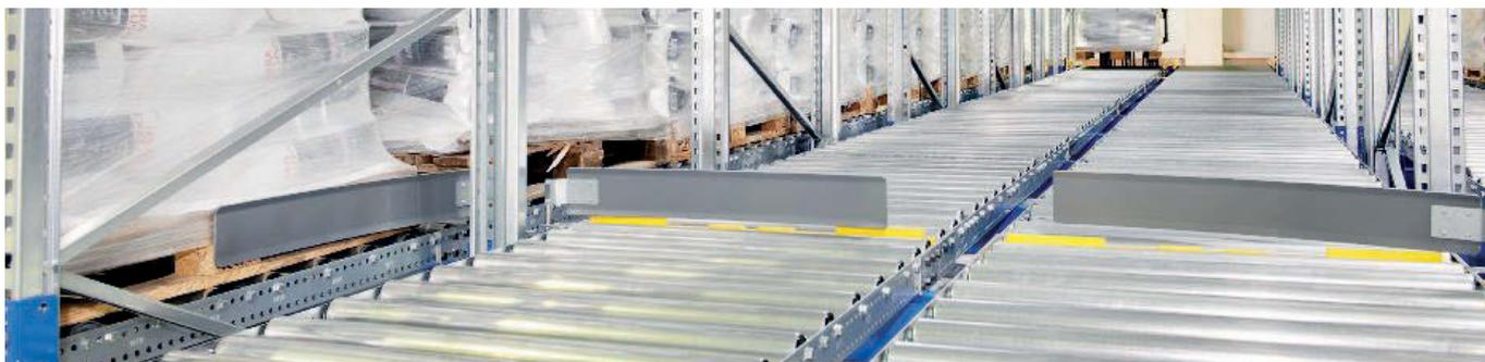
Unsere Nachlaufsperrung FlowStop separiert die Paletten ordnungsgemäß. Der Stapler kann die Palette mühelos und staudruckfrei aus dem Regal auslagern, ohne die Sperre zu beschädigen.
