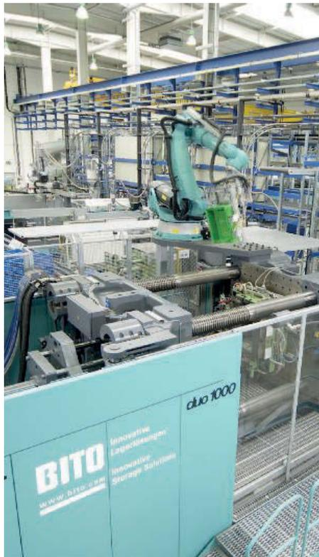
Das Produktionswerk für Kunststoffbehälter gehört zu den modernsten der Branche. BITO-Behälter werden auf leistungsfähigen Spritzgießmaschinen mit einer Schließkraft von bis zu 27.000 kN hergestellt. In dem Veredelungszentrum auf einer Fläche von über 600 qm können die unterschiedlichsten Behälter an kundenspezifische Anforderungen angepasst werden. Der gesamte Produktionsablauf ist gekennzeichnet durch einen hohen Automatisierungsgrad und Flexibilität.
